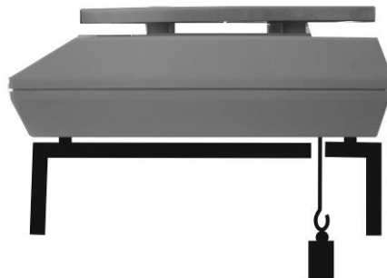
Abb. 1: Einrichten der Waage für Unterflurwägungen
