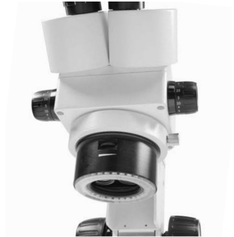
Anneau lumineux LED intégré à intensité variable
