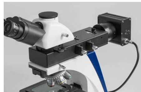
Unidad de iluminación
