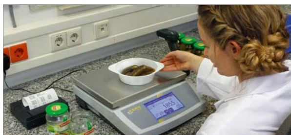
Controllo a campione di un preconfezionato con contenuto svuotato (analisi distruttiva di campione)
