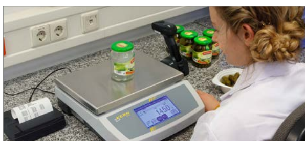
Contrôle d'échantillon d'un préemballage avec poids d'emballage variable, comme les récipients en verre, c-à-d que le poids de tare est indiqué individuellement pour chaque échantillon.
