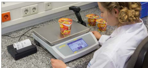
Contrôle d'échantillon d'un préemballage avec tare moyenne c-à-d que le poids d'emballage relativement constant est indiqué en valeur fixe.
