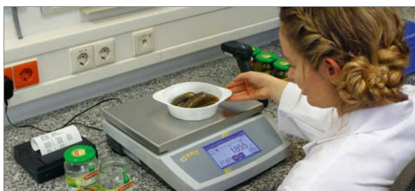
Probenprüfung einer Fertigpackung mit entleertem Inhalt (probenzerstörende Auswertung)
