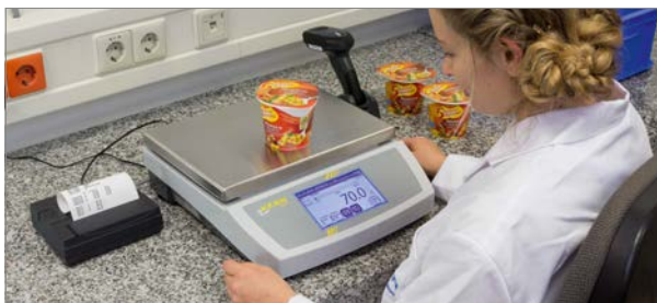
Probenprüfung einer Fertigverpackung mit Taramittelwert d. h. das relativ konstante Verpackungsgewicht ist als Festwert eingegeben
