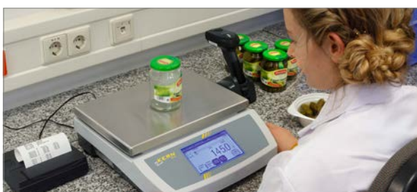
Probenprüfung einer Fertigpackung mit schwankendem Verpackungsgewicht (TARA), wie Glasgefäße, d. h. das Taragewicht wird bei jeder Probe individuell eingegeben
