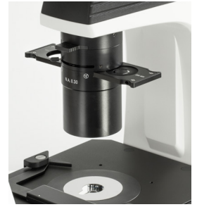
N.A. 0,3 Abbe Kondensator mit Phasenkontrastschieber
