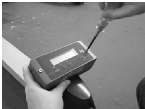
1. Открутить крепежные болты дисплея
