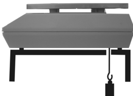
Fig. 1: Preparação da balança para a pesagem suspensa
