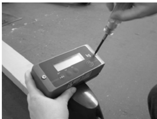
1. Odkręcić śruby mocujące wyświetlacz 2. Wyjąć akumulatory
