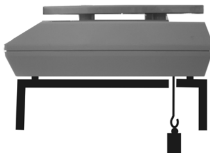
Rys. 1: Ustawienie wagi do ważenia pod podłogą
