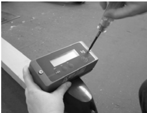
1. Svitare le viti di fissaggio del display
