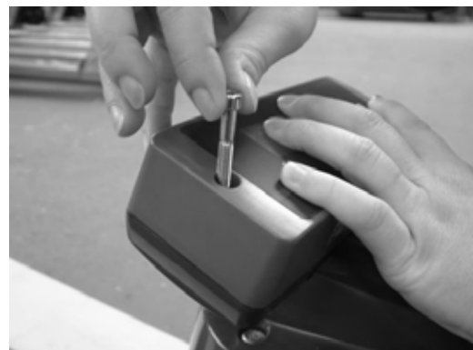
4. Anzeigergerät wieder auf die Halterung schrauben
