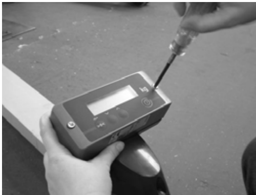
1. Befestigungsschrauben des Anzeigergerätes lösen
