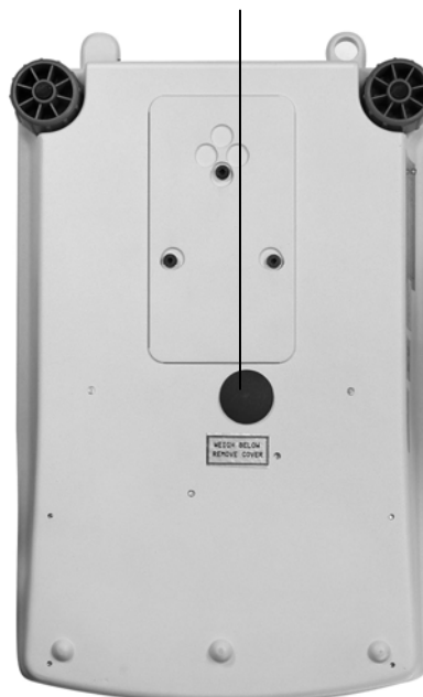
Dispositif de pesée sous-sol
