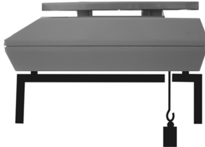
Afbeelding 1 Instellen van de weegschaal voor ondergrondse wegingen
