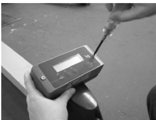
1. Odšroubovat šrouby připevňující displej
