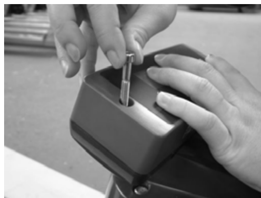
4. Opět připevnit displej do úchytu
